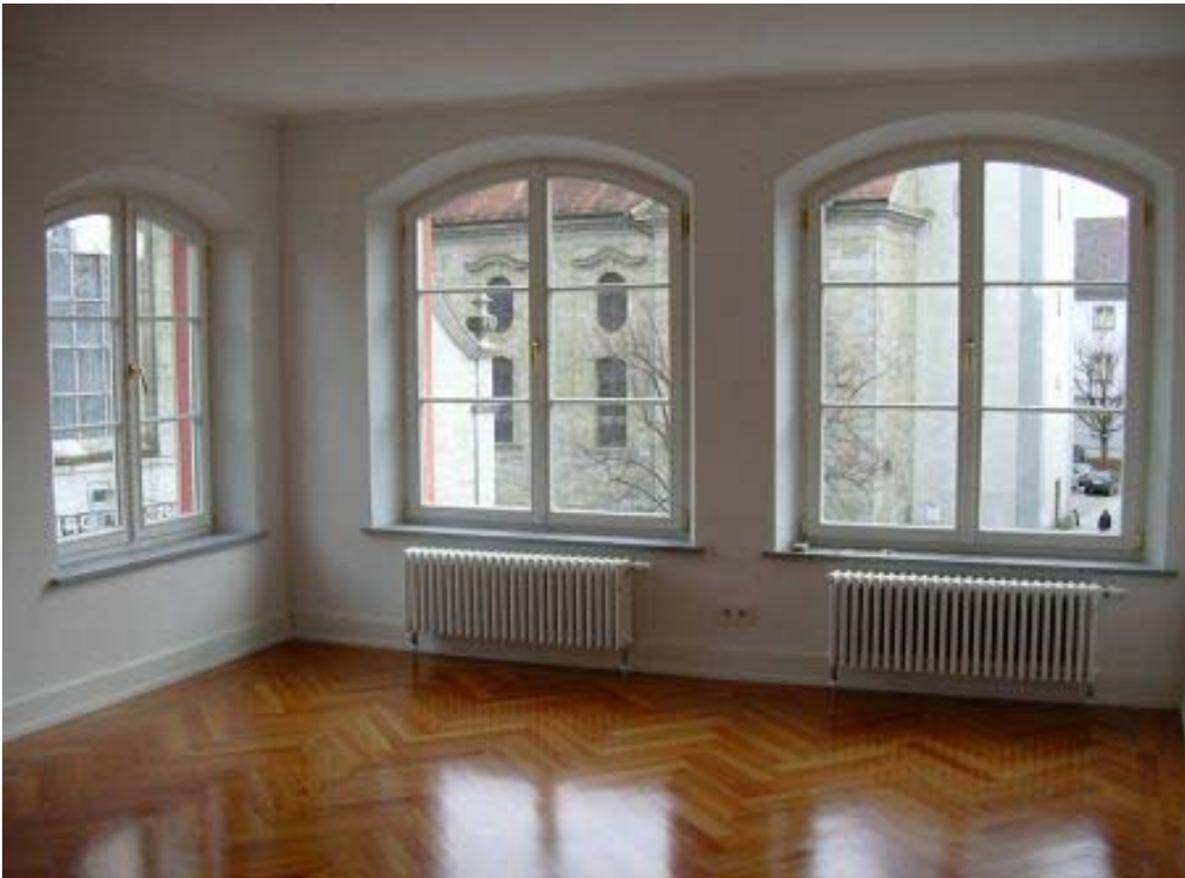
Sanierung eines barocken Hauses am Markplatz in Lindau (4): Nach der Sanierung strahlen Wände und Parkettfußboden wieder im alten Glanz. Besonders sorgfältig rekonstruiert wurden die Holzfenster, alte Sprossen und Formate wurden nach Auflagen der Denkmalpflege originalgetreu rekonstruiert.
